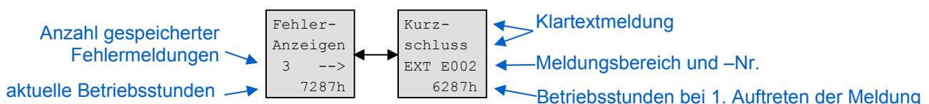
In den Meldungsgrundanzeigen (im Beispiel links) ist zu erkennen, ob bereits Meldungen gespeichert sind. Anhand der angezeigten aktuellen Betriebsstundenangabe kann abgeschätzt werden, wann Meldungen aufgetreten sind. Im obigen Beispiel trat die Fehlermeldung Kurzschluss nach 6287h Betrieb des *ES-ITD* auf, aktuell ist das Gerät *ES-ITD* seit 7287h in Betrieb, d. h. der Fehler trat vor 1000 Betriebsstunden auf.
